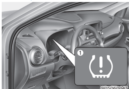
(1) Indicator de presiune redusă în anvelope/ Indicator TPMS defect
